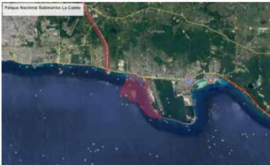
El área de estudio abarcó todo el límite del Parque Nacional Submarino La Caleta según el SINAP (Sistema Nacional de Áreas Protegidas) y la ley 202-04 y se realizó la batimetría de la parte que podría ser navegable y que el equipo pudiera levantar (Entre 4 m y 100 m de profundidad). Para el trazado de las líneas de navegación para el levantamiento batimétrico se hicieron separaciones de 50 metros entre líneas.
