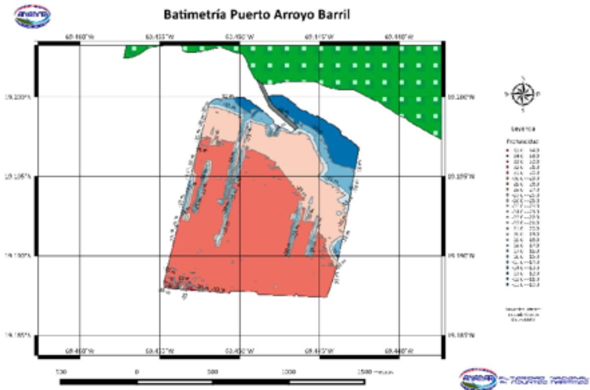
En los levantamientos batimétricos realizados en el 2017, la ANAMAR utilizó un ECO-SONDA MULTHAZ EM 2040C, adquirido recientemente por la institución.
