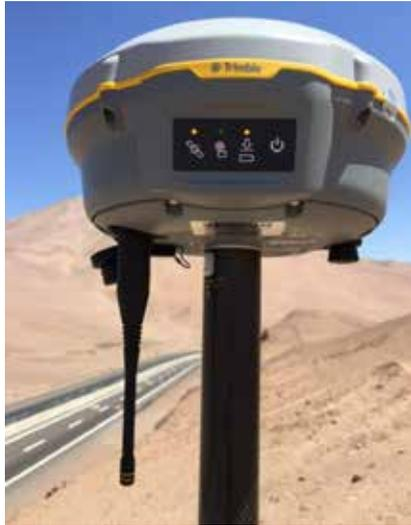
Ilustración 5: GNSS Trimble R8S
